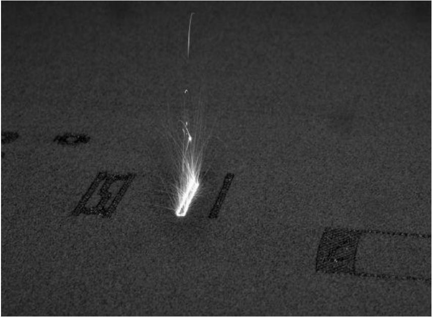
图5-7 一束激光正在熔融金属粉末，打印过程完成后物体最终被埋在粉末下
