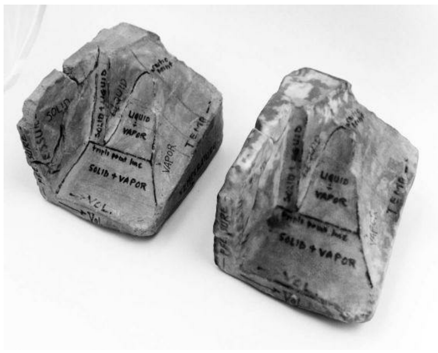
图9-7 热力学PVT泥塑模型，原始模型（左）和3D打印的复制品（右）
