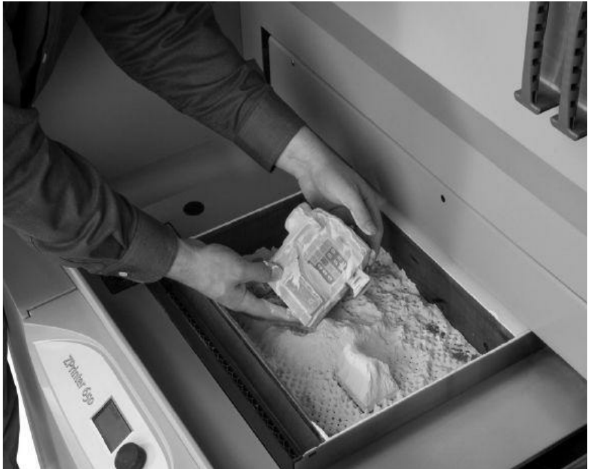
图5-10 将打印好的物体从粉床上拣出并清理
