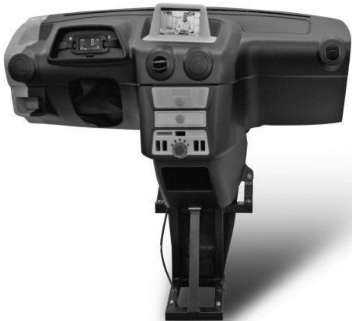
图3-2 3D打印机打印出的实际大小的卡车驾驶室—各部件完整
