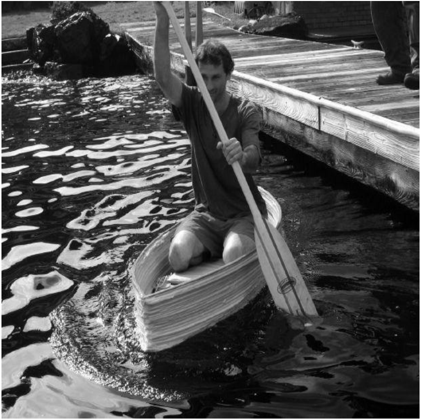
图11-4 使用废牛奶盒磨粉制成的3D打印塑料船
