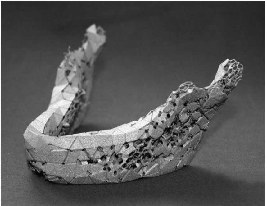
图7-4 一个新“出炉”的用金属粉末制造的下颌骨植入物
