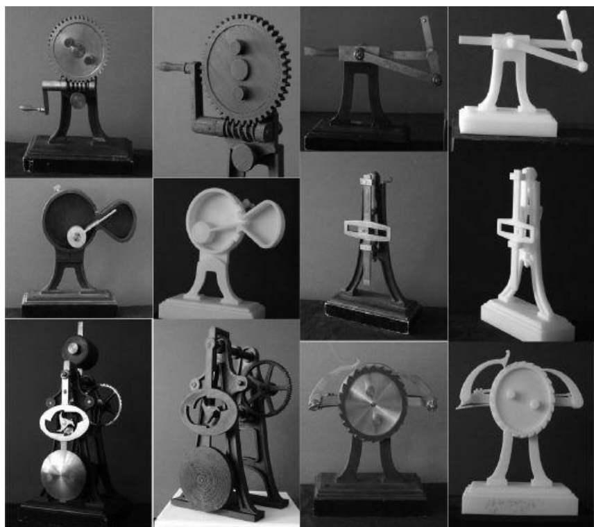
图9-5 博物馆展出的19世纪机械和下载后3D打印的复制品
