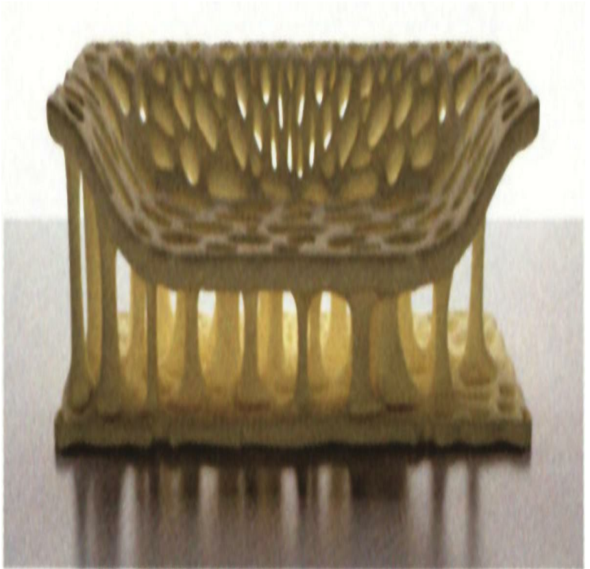
用石质材料打印的全尺寸长凳
