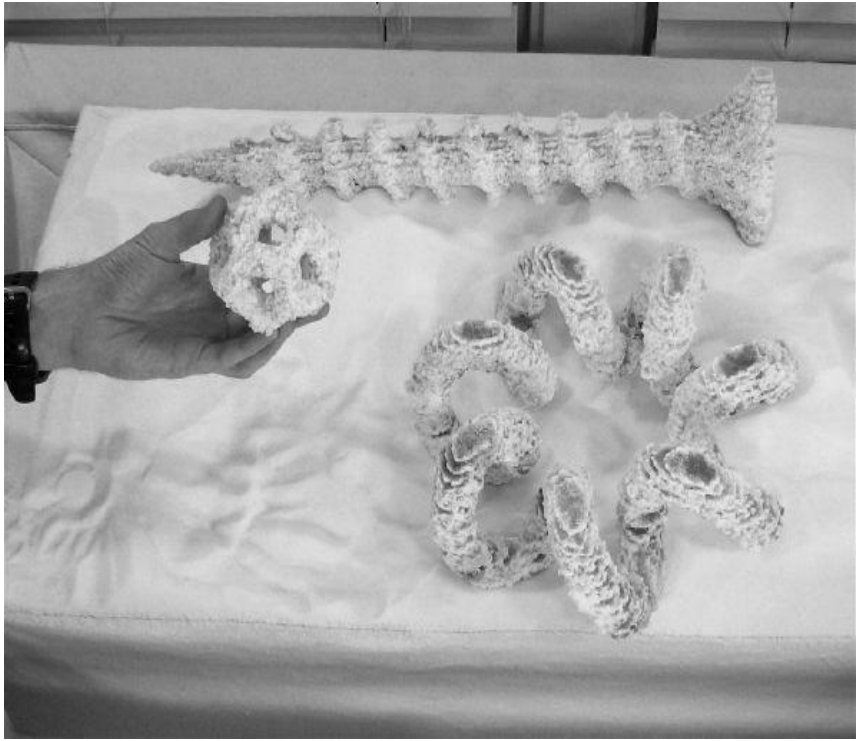
图8-6 加热原件熔融糖形成3D形状，不需要附加装配过程
